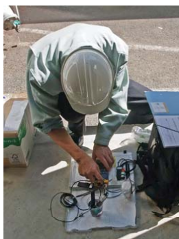
1ヶ月毎の点検時に、水質測定を行い、水質浄化システム設置による水質の変化を確認しております。
